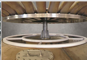
Central valve hydraulic lifting system Hydraulisches Hebesystem mit Zentralventil
