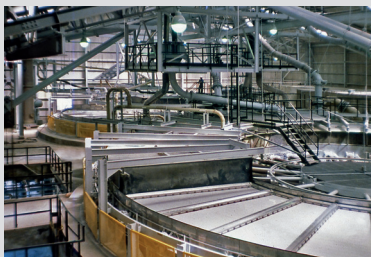
Tilting pan filter for phosphate industry Vakuumpfannenfilter für die Phosphatindustrie
