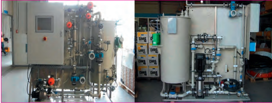
Abb. 2: Pilotanlage zur kombinierten Wasserfiltration mit photokatalytischem Schadstoffabbau (Bild: EnviroChemie GmbH)
