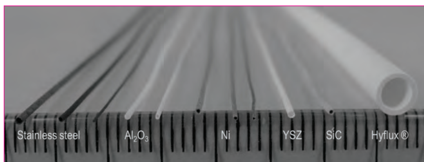
Abb. 5: Ansicht der neu entwickelten Hohlfasern im Vergleich zu einer kommerziellen Hohlfasermembran aus Al 2 O 3 (rechts außen) (Bild: Inorganic Membranes Group, Fakultät für Science and Technology, University of Twente)
