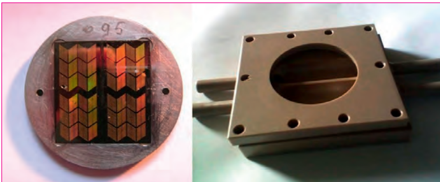
Abb. 3: Mikrosieb (links) und Modul (rechts) für die Produktgewinnung in einem Bioreaktor (Bild: Aachener Verfahrenstechnik (AVT), RWTH Aachen)
